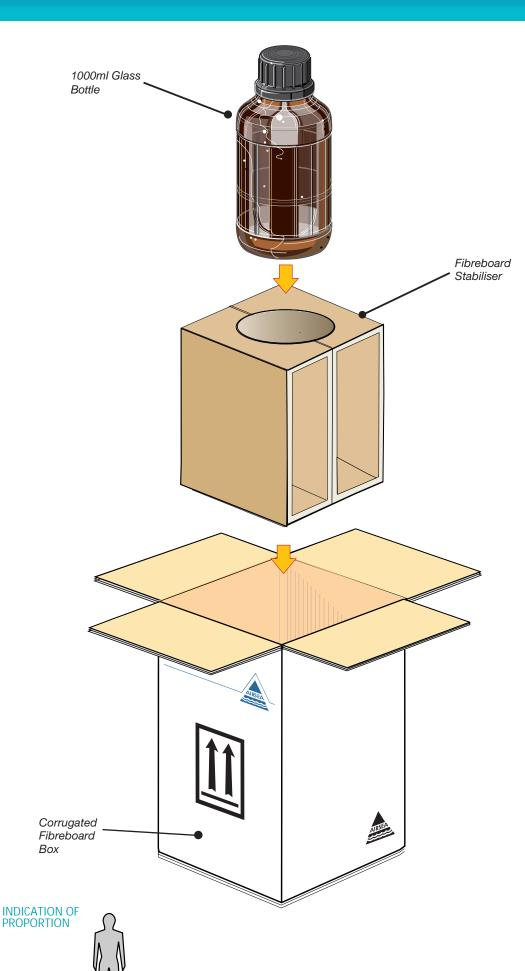
**ASSEMBLY DETAILS: FIBREBOARD Q** OUTER
